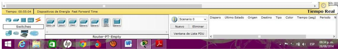
también hay dos modos en las redes concretadas, uno en el modo real, en donde se crean las configuraciones y se dispone la posición de los dispositivos; y el modo simulación en el cual se pone a andar la o las redes armadas. Se puede cambiar entre los diferentes modos, esto está en la parte inferior derecha. El modo real (Realidad) es representado por un reloj, y el modo simulación (Simulación) es representado con un cronometro.
